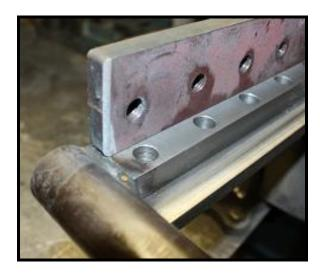
**Step 3.** Welding The Bottom Die Into Position
